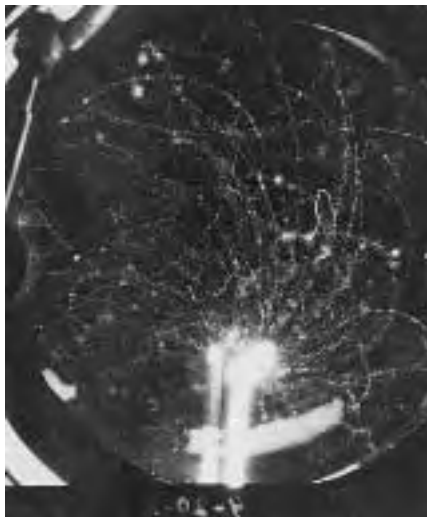
霧箱写真の1例(過飽和状態の気体中を荷電粒子が通過すると、経路に沿つて霧が発生する。磁場中で荷電粒子は円弧を描き、それから荷電の正負や運動量が分かる。)
