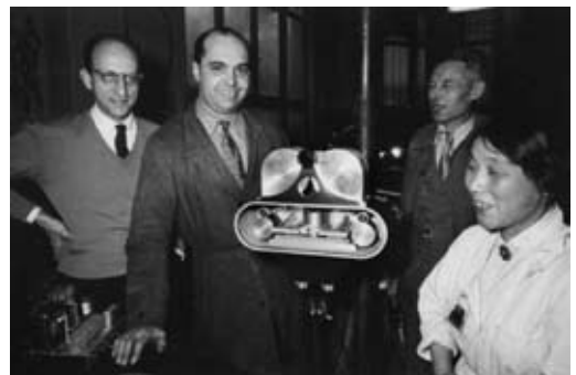
写真8 長時間有効なウィルソン霧箱の撮影システム
